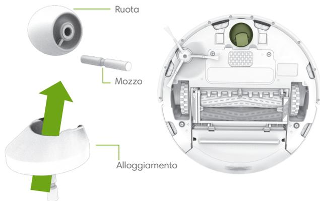
**⚠ Importante:** Una ruota anteriore con capelli e detriti incastrati può danneggiare il pavimento.
