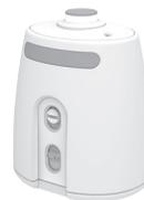
**Modalità Virtual Wall:** Quando l'interruttore è in posizione "Virtual Wall", il dispositivo funge da Virtual Wall. In questa modalità è possibile impostarlo per bloccare le aperture fino a 2.4 metri. Viene creata così una barriera invisibile e cuneiforme rilevabile unicamente dal Roomba.
